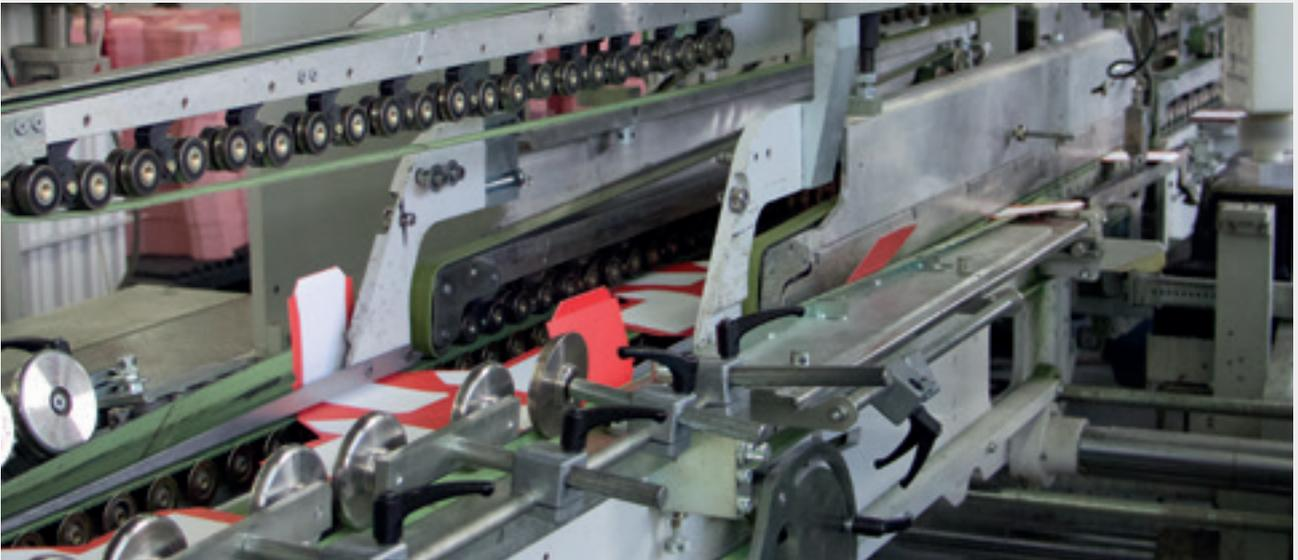
Pour terminer le processus de fabrication de l'emballage, les pièces découpées sont traitées sur des machines de collage.
